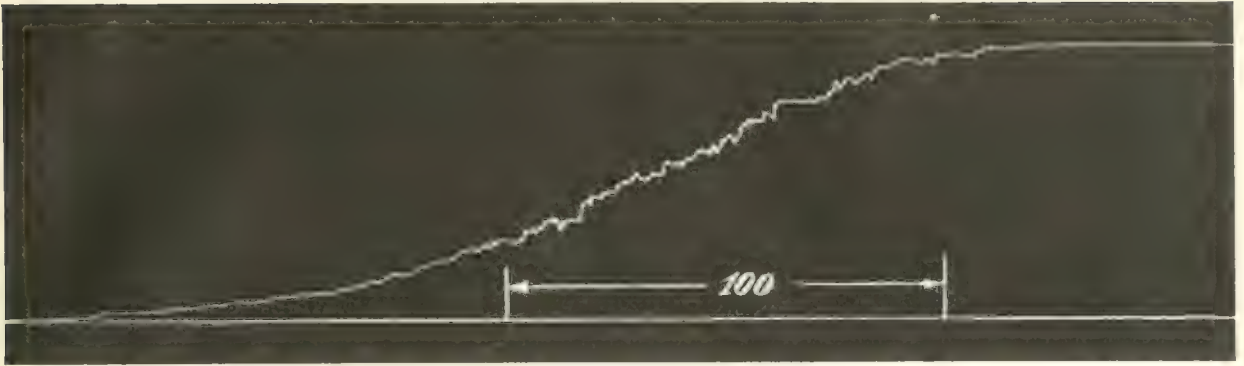
Abb. 78. Verlauf des Staudruckes am Rande der Düse des großen Versuchskanals. Abstand vom Düsenrand a = 112 cm, Staudruck des ungestörten Strahles q = 56 kg/m 2 .
