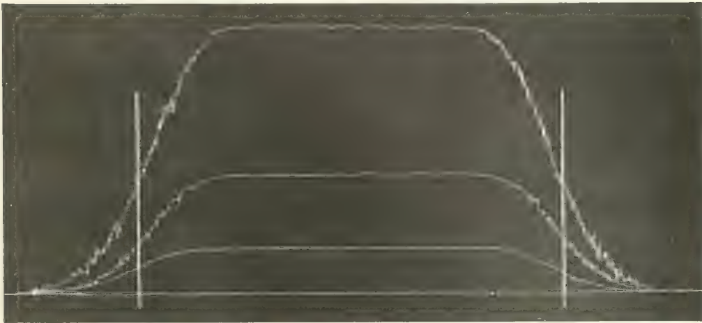
Abb. 74. Freier Strahl. a = 25 \text{ cm} , q = \begin{cases} 99 \text{ kg/m}^2 \\ 42 \text{ ,,} \\ 16,2 \text{ ,,} \end{cases}
